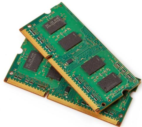
Las memorias RAM se utilizan para almacenar datos y programas. Los datos provienen de procesos y algoritmos y pueden ser resultados parciales o finales. Los programas se almacenan en discos duros y medios ópticos y para ejecutarlos o procesarlos, tienen que pasar primero a la memoria RAM para su ejecución. Las memorias RAM se usan también durante la edición, ensamble y depuración de los programas.
