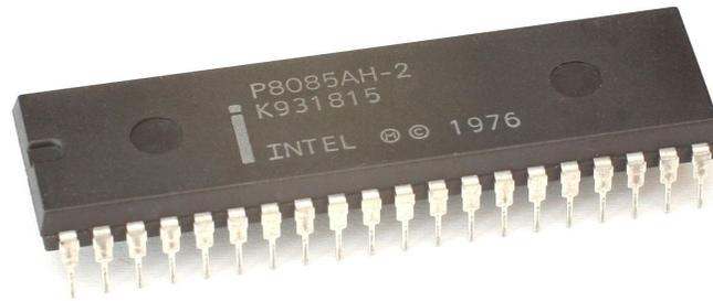
Imagen. 1.4 Chip Intel 8085, su encapsulado cuenta con 40 pines (contactos o patillas), 20 de cada lado. Imagen obtenida del manual del circuito
