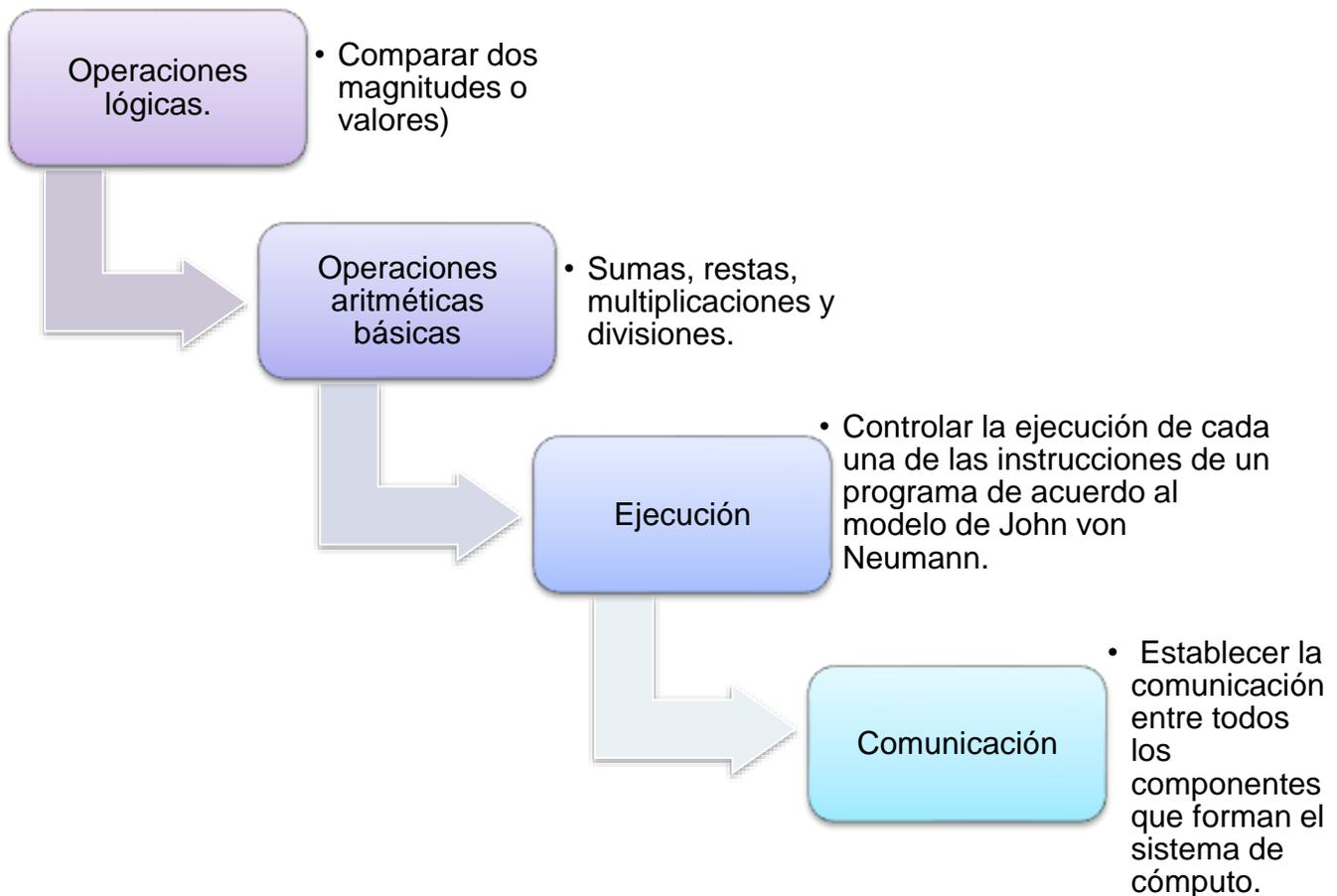
La unidad central de proceso (CPU) está constituida, básicamente, por registros de memoria (UM), la unidad aritmético-lógica (ALU) y una unidad de control (UC). En la actualidad, todos los microprocesadores incluyen un co-procesador matemático que permite almacenar datos sobre los cuales debe realizar cálculos matemáticos con números decimales, lo que conlleva elevar la capacidad y eficiencia de la unidad aritmético-lógica.
