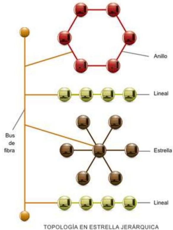
En esta topología, la señal generada por un dispositivo es enviada al concentrador, el cual la transmite al otro *hub* conectado en el canal, y de este concentrador llega al dispositivo destino.
