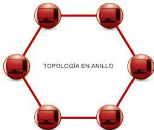
Es posible establecer una red con topología en anillo doble, que consta de dos anillos concéntricos, donde cada dispositivo de la red está conectado a ambos anillos, aunque éstos no aparezcan conectados directamente entre sí.
