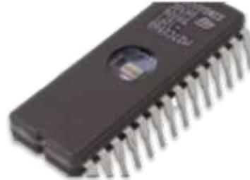
Esta memoria de sólo lectura está conformada por una serie de circuitos electrónicos con programas previamente definidos por el fabricante para el funcionamiento de la computadora. Por ello, se dice que viene "de fabricación".
