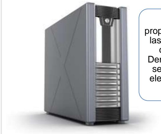
Se encargan de proporcionar los servicios a las estaciones de trabajo conectadas a la red. Dentro de estos servicios, se encuentran el correo electrónico, impresoras y bases de datos.
