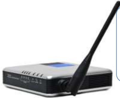
Dispositivos que amplifican la señal emitida por un segmento de una red hacia otro, con el fin de incrementar el alcance de las mismas redes.
