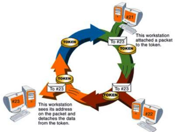
de dispositivo en dispositivo hasta llegar a alguno que requiere efectuar una transmisión. Cuando sucede esto, es incorporado al testigo la dirección del dispositivo emisor, la dirección del dispositivo receptor y los datos que se van a enviar, y así va pasando de dispositivo en dispositivo hasta llegar a su destino.
