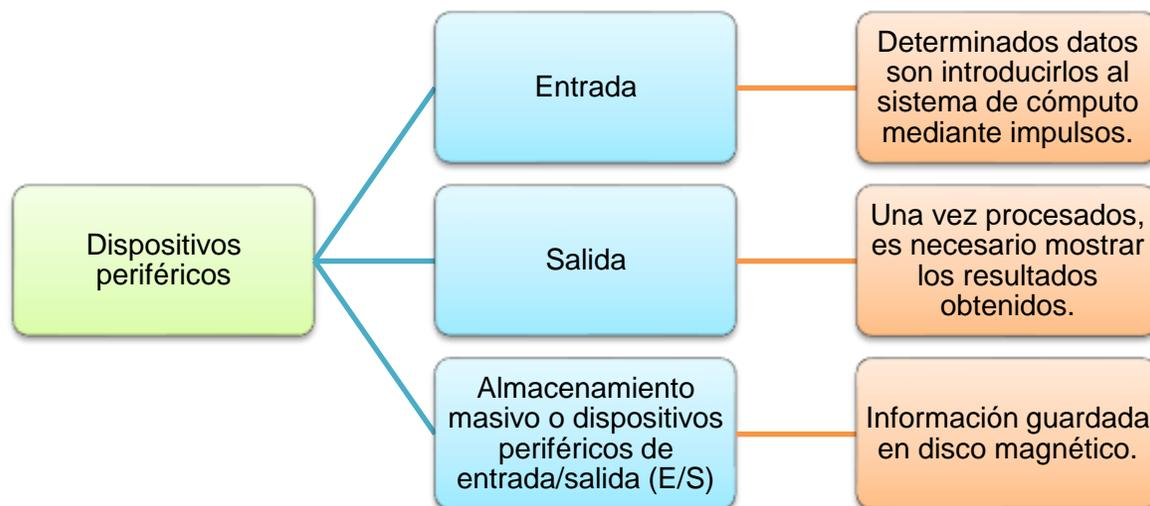
Para llevar a cabo un proceso es necesario tener determinados datos, e introducirlos al sistema de cómputo mediante impulsos producidos por el teclado, el ratón o una pantalla sensible al tacto (o pueden ser recibidos a distancia mediante un módem o tarjeta de red). Estos datos se almacenan o guardan en un disco magnético, fijo o removible para facilitar su acceso. Y una vez procesados, es necesario mostrar los resultados obtenidos, lo que se realiza a través del monitor o en un reporte impreso.
