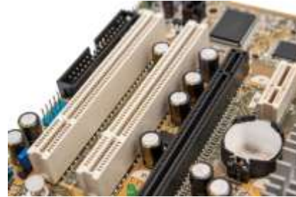
Ejemplos de diferentes tipos de ranuras de expansión
