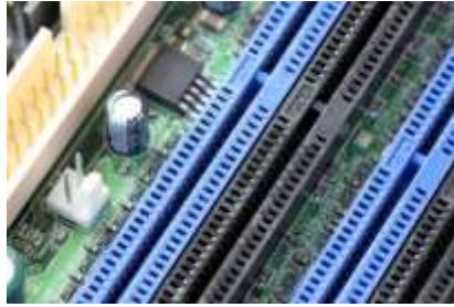
Ejemplos de diferentes tipos de ranuras de expansión
