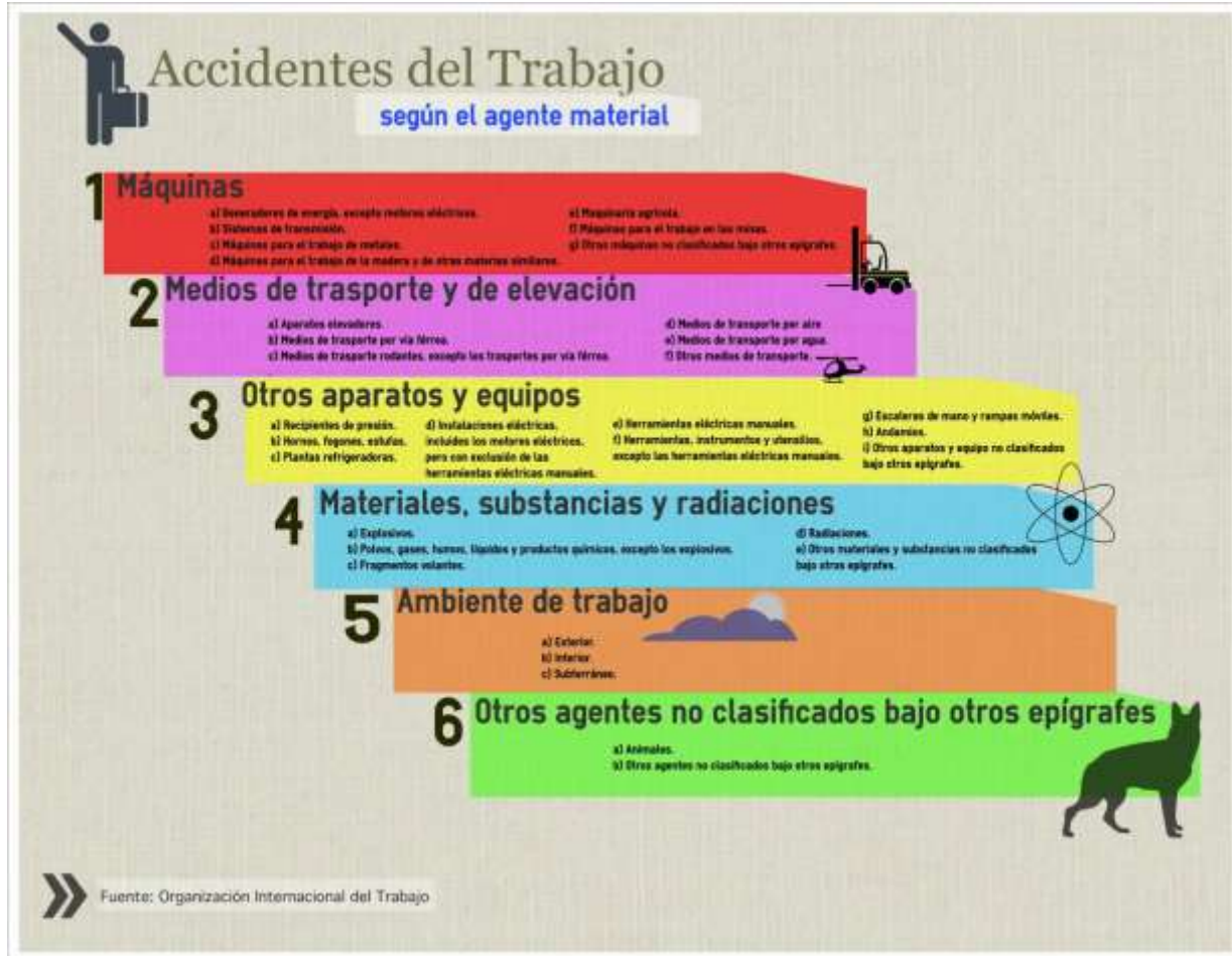
(s. a.) (s. f.). Clasificación de los accidentes del trabajo, según el agente material (causas) [diagrama]. Tomado de Organización Internacional del Trabajo (OIT)(2014).
