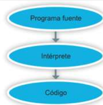
FUNCIONAMIENTO DE UN INTÉRPRETE.
