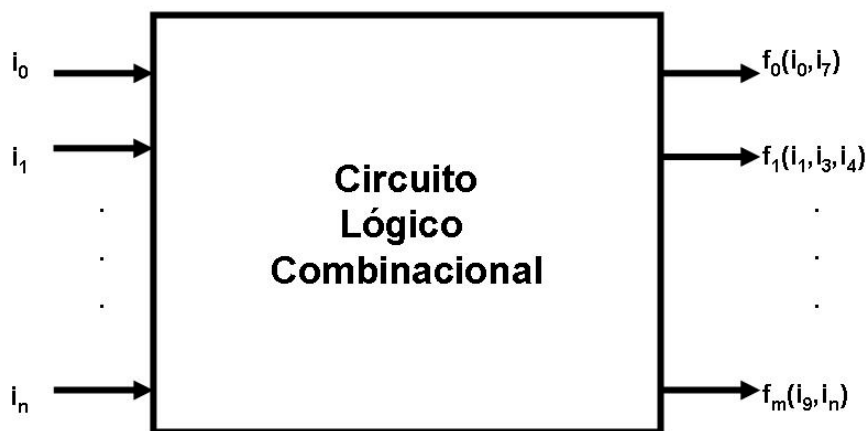
Diagrama en bloques de una unidad lógica combinacional
