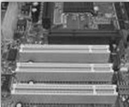
Ejemplos de diferentes tipos de ranuras de expansión
