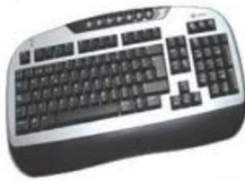
Como todo va evolucionando, este dispositivo no es la excepción, por lo que vemos en el mercado diferentes modelos: original PC o XT, AT original o el de 101 teclas. Algunos no son compatibles con ciertos modelos de computadora, mas es posible utilizarlos en cualquier computadora colocando un interruptor XT/AT en el teclado. El teclado de 101 teclas trabaja con cualquier computadora sin necesidad de modificación.
