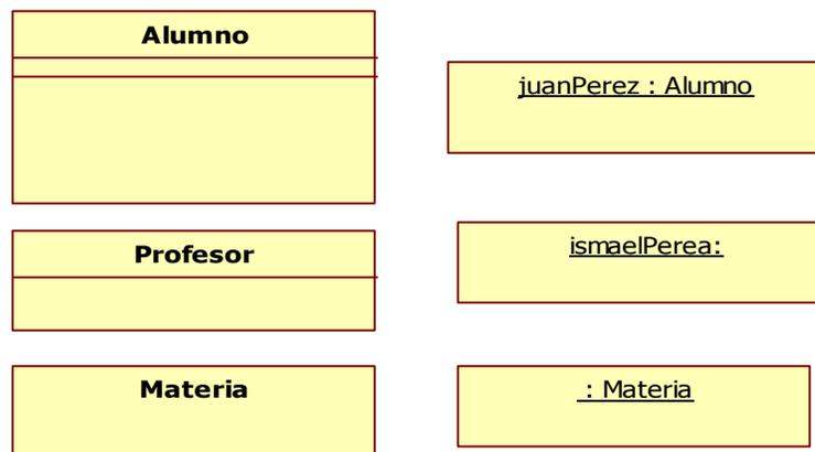
Figura 3.1. Tokens o símbolos de UML que se utilizan para modelar clases y objetos
